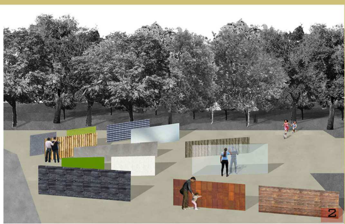
PANNELLI IN CEMENTO ARMATO RICOPERTE DI MATERIALI DIVERSI (ES. ASFALTO, ANTITRAUMA, LAMINATO, LISTELLI DI LEGNO BOMBATO, ACCIAIO, CEMENTO, CONGLOMERATO DI PIETRISCO, PLASTICA, TRAVERTINO, VETRO ANTI-SFONDAMENTO, ARDESIA, COR-TEN).
