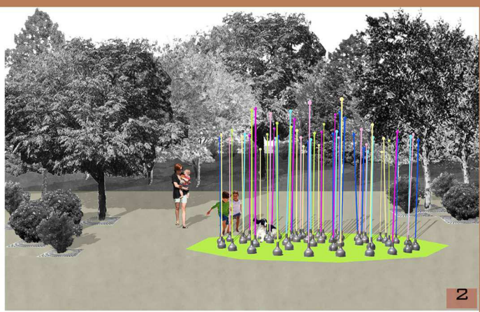
ASTE DI ACCIAIO CAVE CHE SI MUOVONO AL CONTATTO GRAZIE A UN SISTEMA A MOLLA E CHE PRESENTANO UN CAMPANELLO NELLA LORO ESTREMITÀ SUPERIORE.
